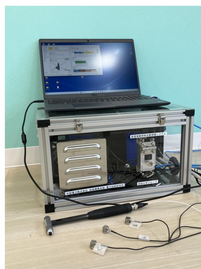
図3 配管振動抑制ティーチングシステム（第二世代）
