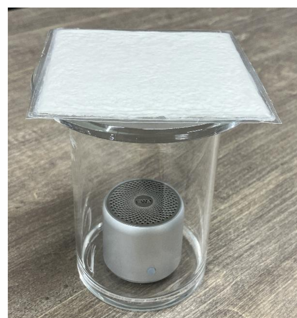
防音効果体感のデモ実験 (塗膜有無による音量差)
