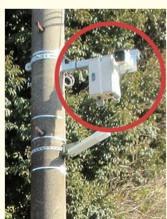
電柱への設置例
